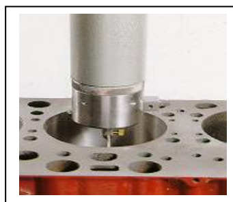
Центрирование с помощью MAC-CR
