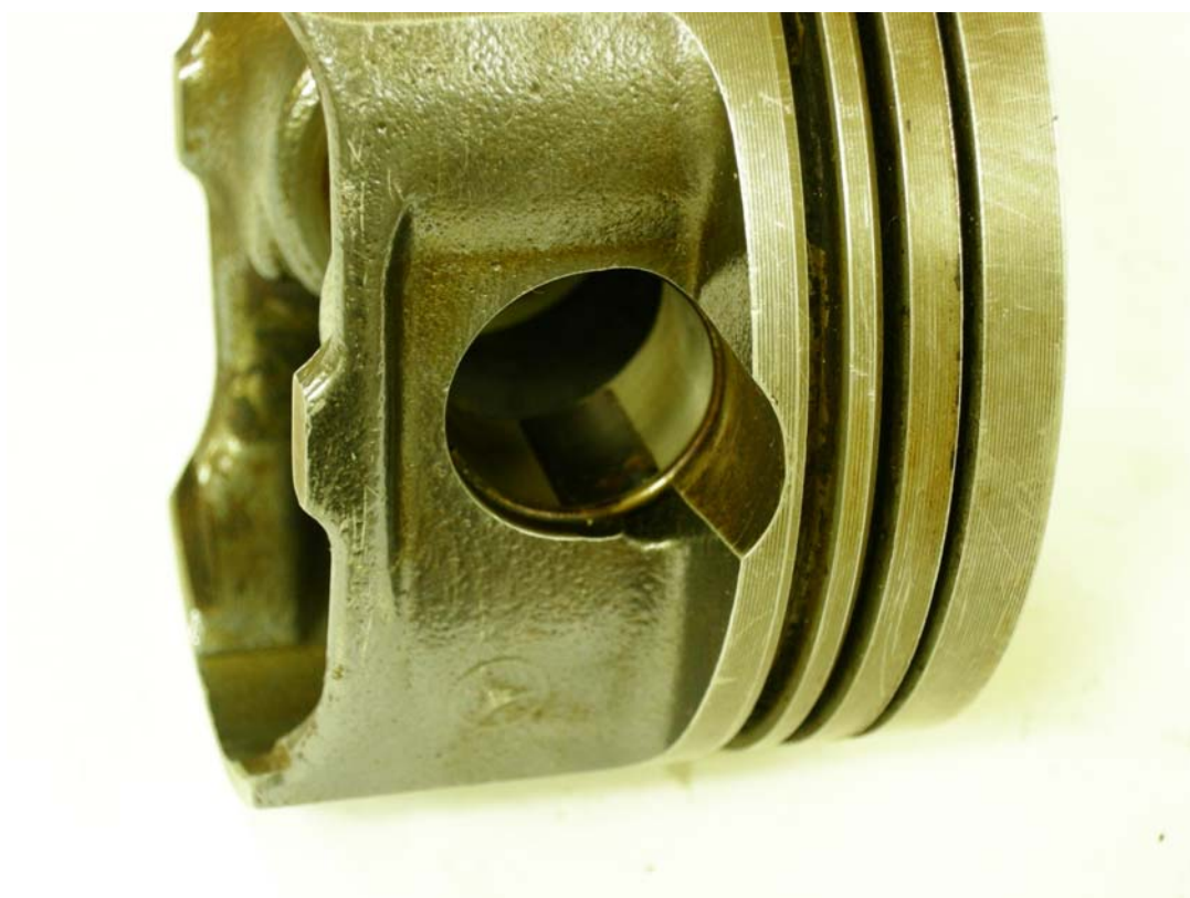
Рис. 7. Смазочная канавка в отверстии для пальца работавшего поршня.
