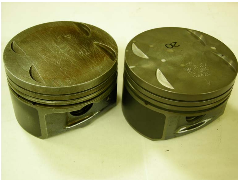
Рис. 1. Образцы поршней – справа Kolbenschmidt, слева – работавший образец.
