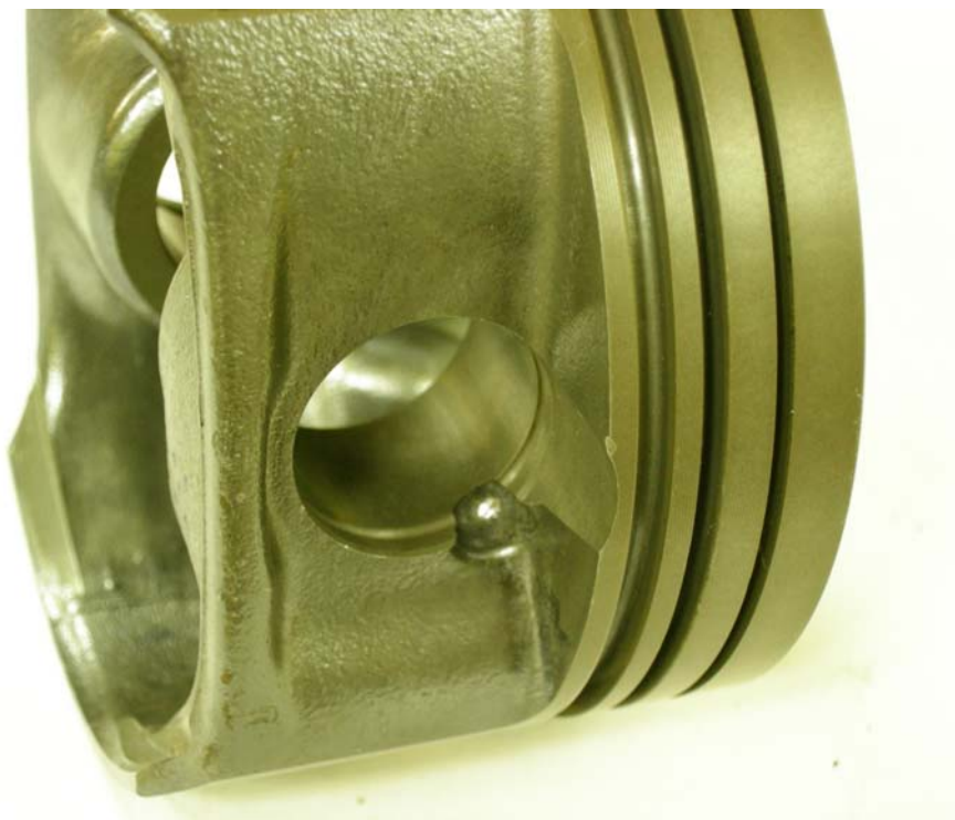
Рис. 8. В отверстии поршня Kolbenschmidt смазочные элементы отсутствуют, поскольку смазка осуществляется за счет расширения (овальности) отверстия в горизонтальной плоскости
