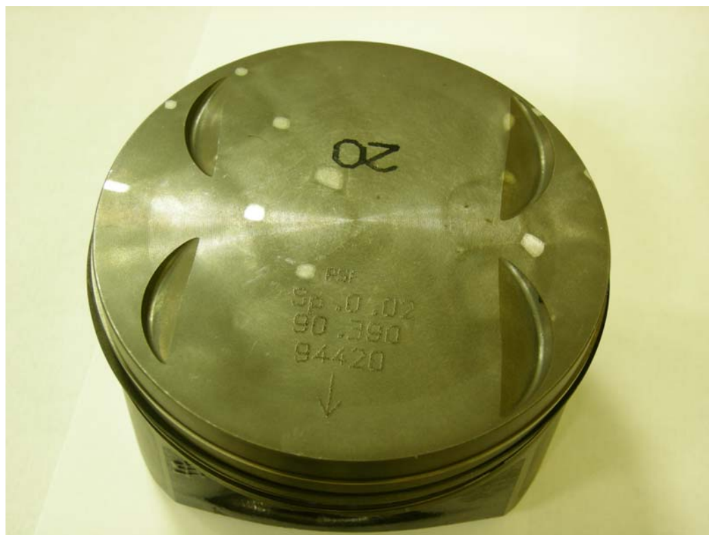
Рис. 23а. Маркировка поршня Kolbenschmidt с информацией о его размере и минимальном зазоре в цилиндре.
