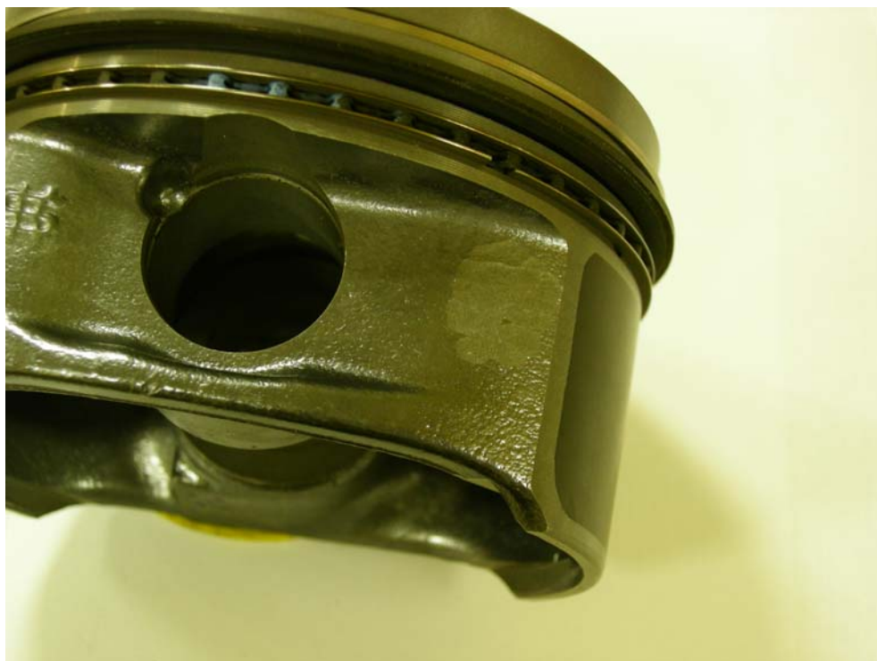
Рис. 5. Зашлифованное место на поршне Kolbenschmidt предположительно свидетельствует о том, что ранее такие поршни поставлялись компании Mercedes-Benz в качестве "оригинальных" деталей.
