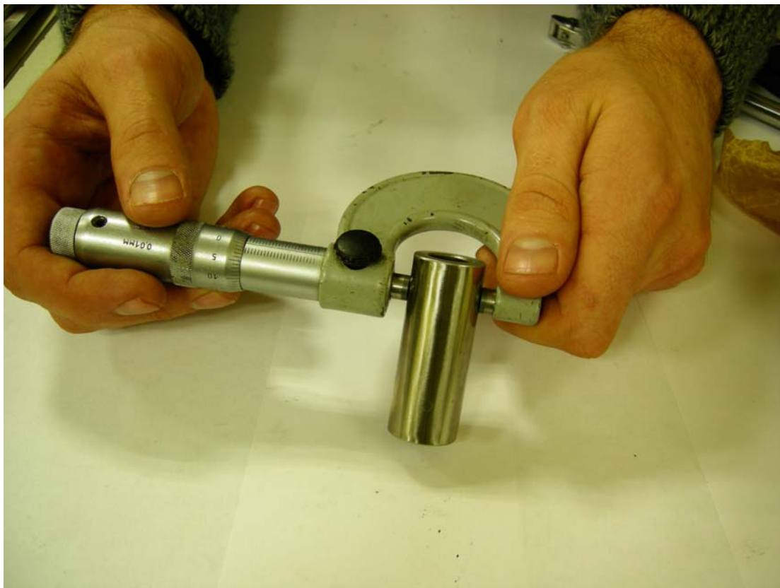
Рис. 12. Измерение диаметра поршневого пальца микрометром.
