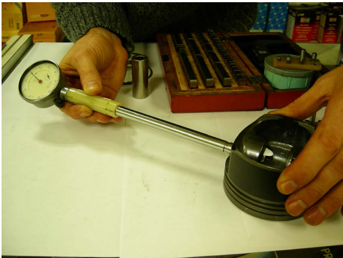
Рис. 13. Измерение размера отверстия для пальца нутромером.
