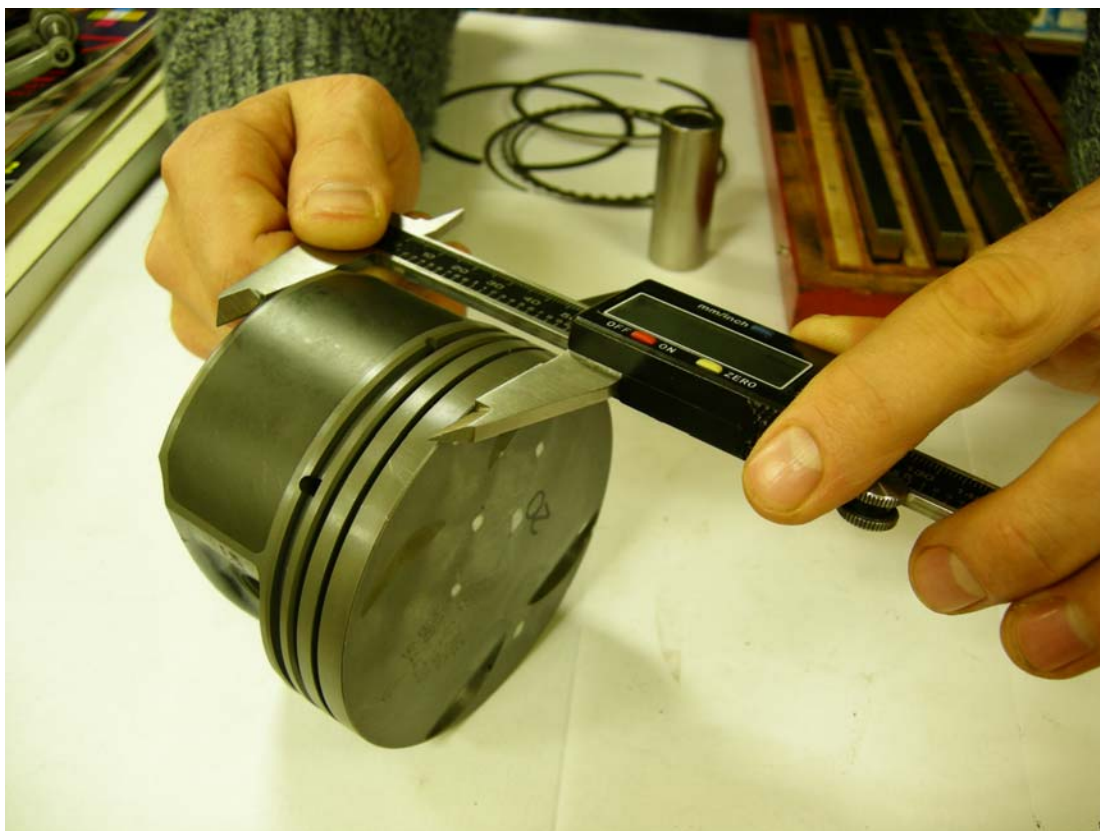
Рис. 10. Измерение высоты поршня штангенциркулем.
