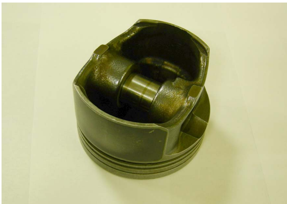
Рис. 5. Зашлифованное место на поршне Kolbenschmidt предположительно свидетельствует о том, что ранее такие поршни поставлялись компании Mercedes-Benz в качестве "оригинальных" деталей.
