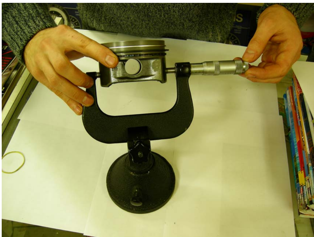
Рис. 9. Измерение размера (диаметра) поршня микрометром.
