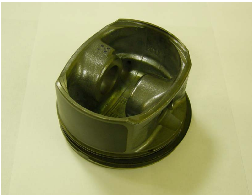
Рис. 6в. Внутренняя конфигурация поршня Kolbenschmidt.
