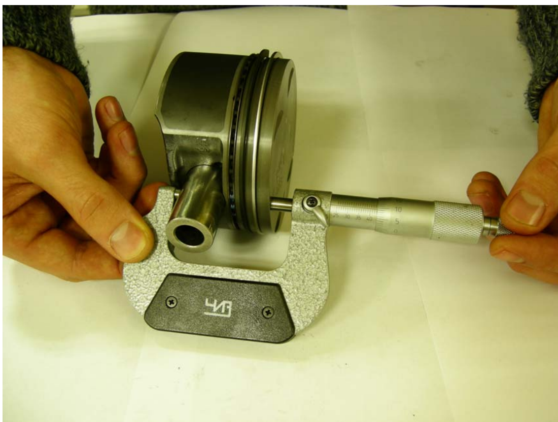
Рис. 11. Измерение компрессионной высоты поршня микрометром.
