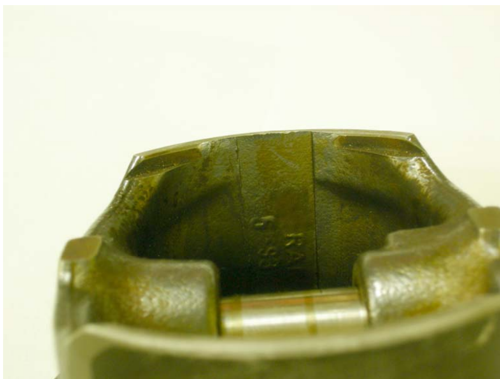
Рис. 2. Маркировка ранее стоявшего в двигателе поршня.
