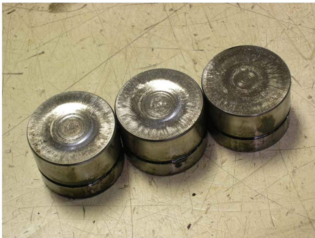
Рис. 8. Износ стаканов гидрокompенсаторов.
