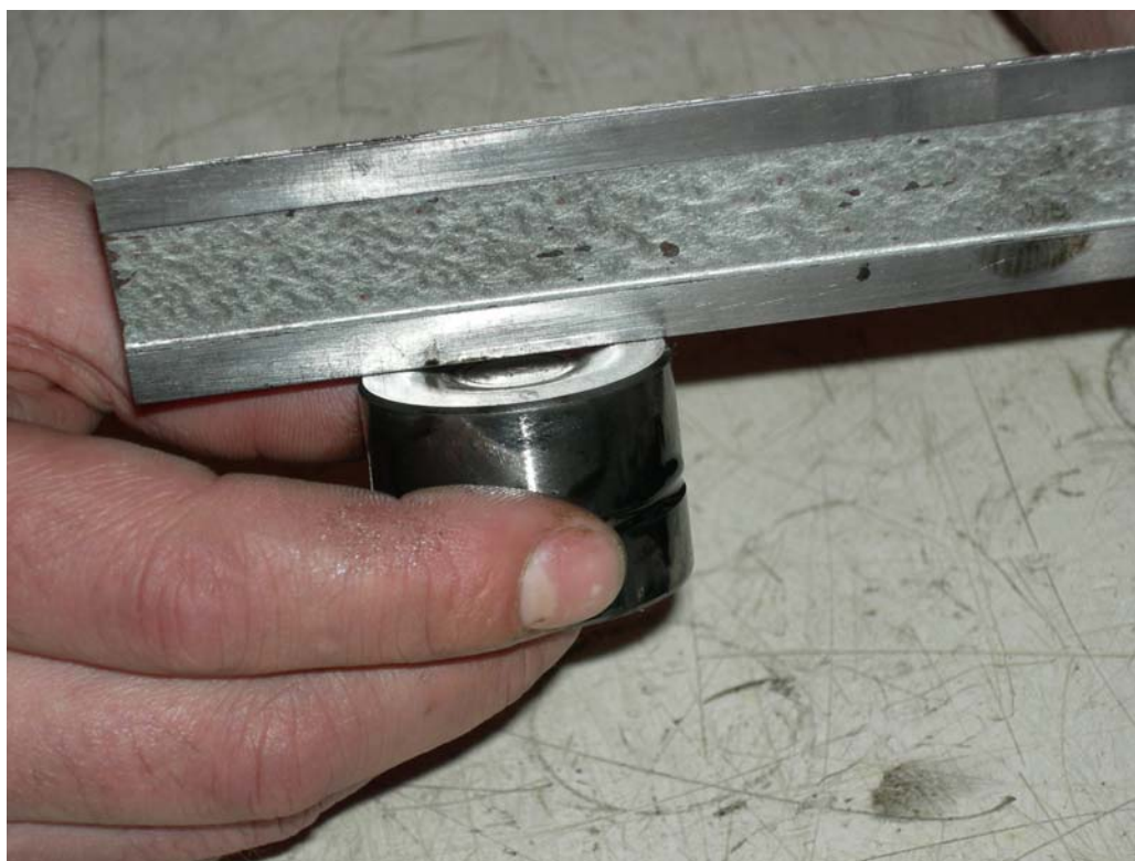
Рис. 10. Глубина износа рабочей поверхности гидрокомпенсатора.
