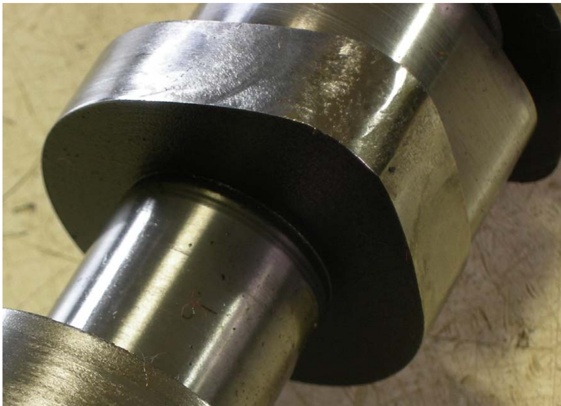
Рис. 3. Характерное "заваливание" краев вершины изношенного кулачка.
