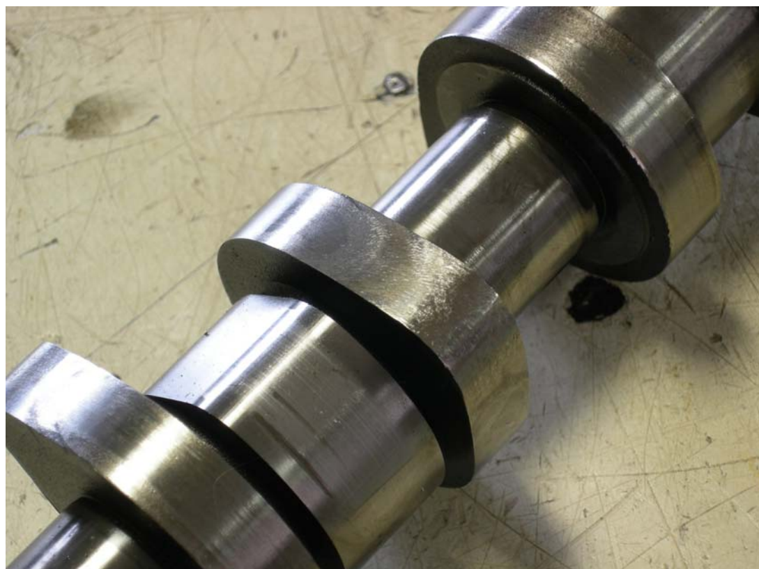
Рис. 2. Износ кулачков распределительного вала.
