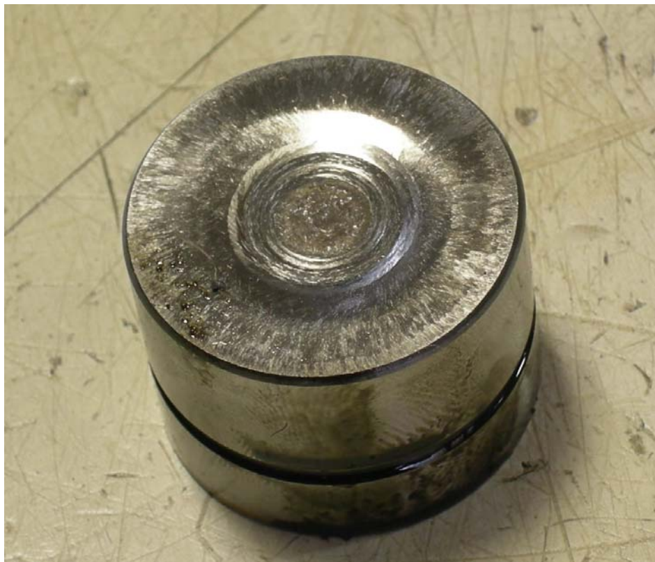
Рис. 9. Сильный износ средней части рабочей поверхности стакана.
